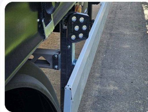
Фонарь в рабочем положении: выдвинут на 15 см.
