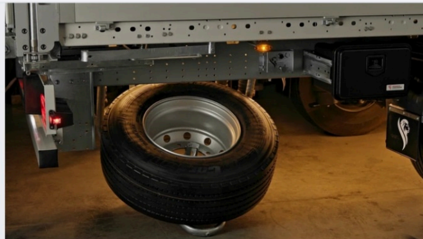
Пневматическое опускание и подъем корзины запаски.
