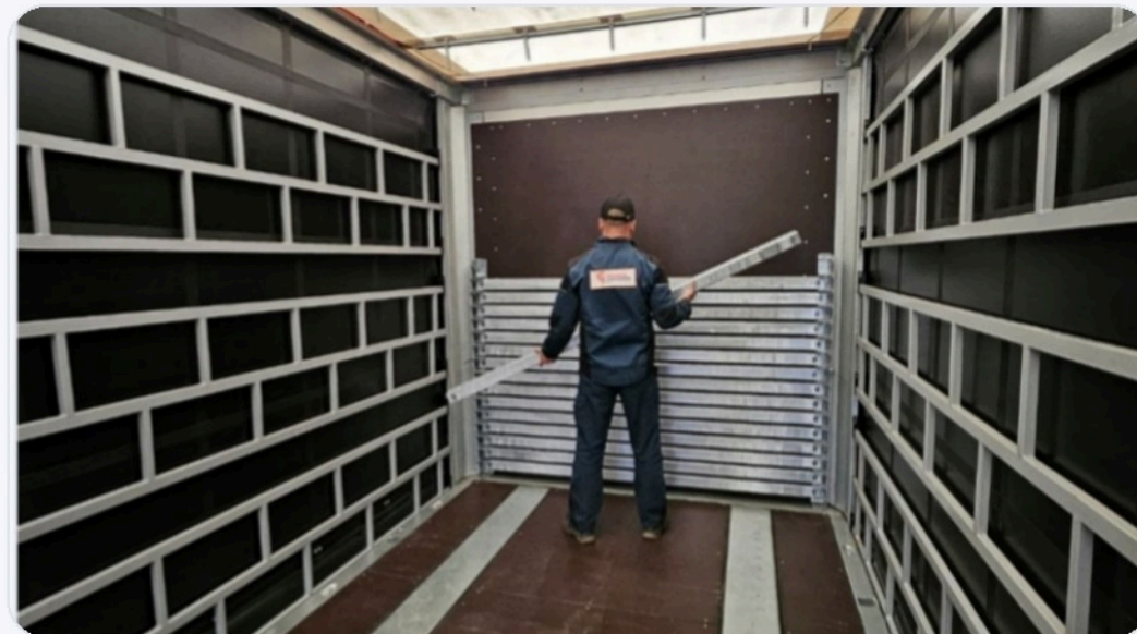
Коники длиной 2200 мм хранятся внутри грузового пространства на передней стенке. Коники и система хранения - горячее цинкование.
